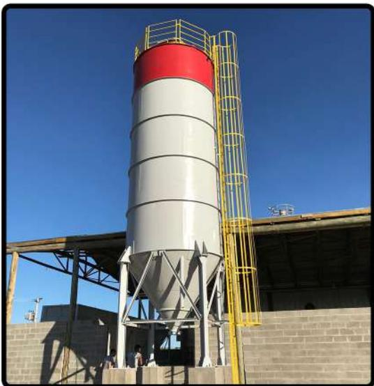
Os silos para armazenamento de cimento entre outras matérias prima. Equipamento robusto, construído em chapa preta, reforços em cantoneira, ferro chato e viga U.
