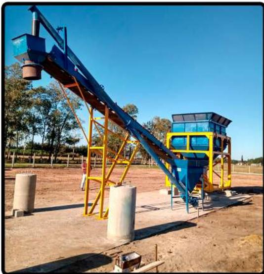
Centrais para fabricação de concreto usinado podendo ter uma ou mais cubas. Capacidade: 20 a 50 m<sup>3</sup>/h
