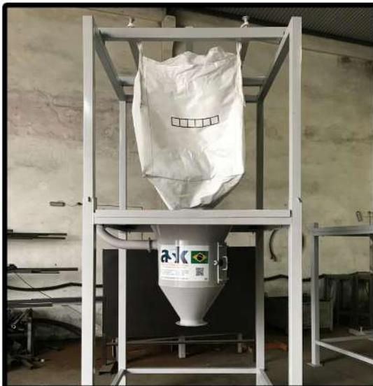
Possui mesa em chapa onde é apoiado o fundo do bag que conta com membrana de borracha para evitar os particulados em suspensão.
