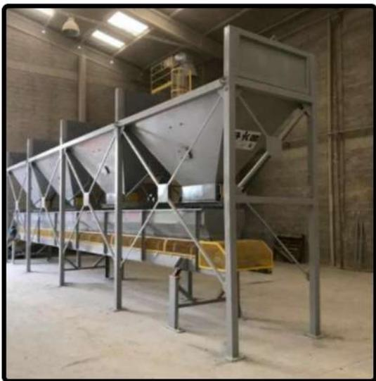
Pesagem através de células de carga + indicador para porta de painel ou módulo interno.
