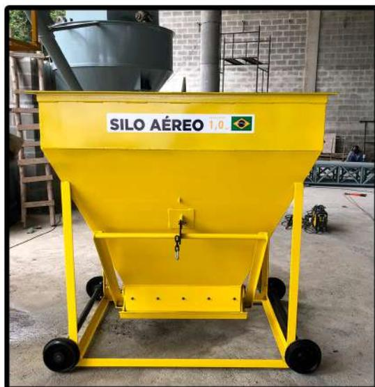
Silos para o transporte de concreto até as formas ou local para descarregamento de concreto em formas ou obras externas.
